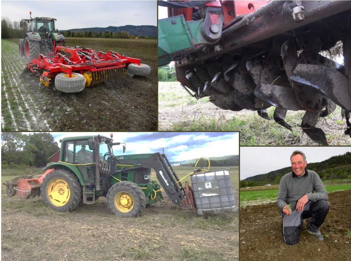
Bilde 3. Utstyr brukt til flatekompostering. Dyser og pallettank for utsprøyting av ferment. Fresen ble i 2019 byttet ut med Väderstad carrier med crosscut-skåler som sletter ut grønnsaksbed og hjulspor godt, noe som gir mindre problemer med planter som frør seg i hjulsporene. I forhold til fresen ble også kapasiteten vesentlig bedret, da man kan kjøre opptil 20 km/t. Nederst i høyre hjørne, feltvert Anders Hørthe.
