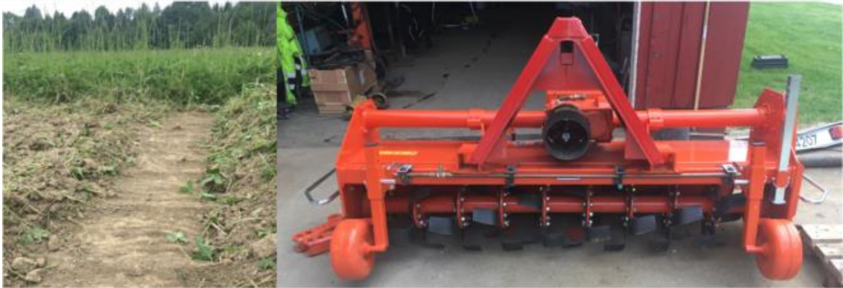
Bilde 1. Flatekompostert mellomvekst med vertikalfres med L-kniver. Fresedybde er typisk 2-3 cm første gang og litt dypere ca 1 uke senere. Hensikten er å lage en luftig blanding av bladmasse, jord og ferment som komposteres/starter omdanning på jordoverflaten. Man må samtidig passe på å frese tilstrekkelig dypt slik at av plantekulturen ikke kommer igjen fra rota.
